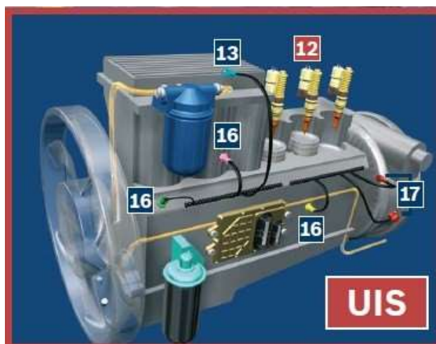
Figura 46. Sistema de injeção eletrônica diesel UIS. Fonte:
